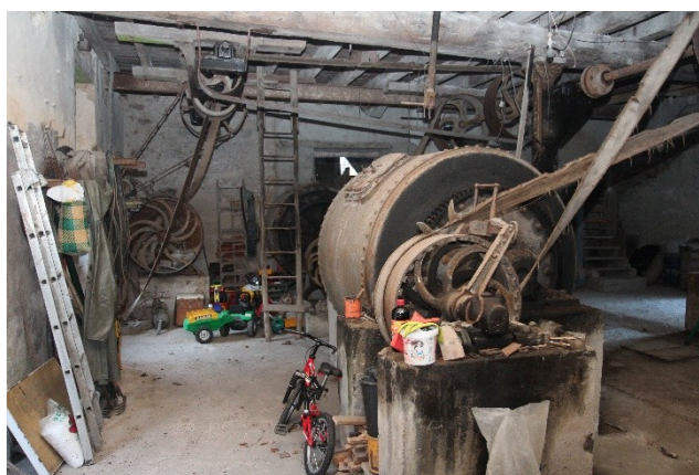
Moulin Mausset à Bosmie l'Aiguille : broyeurs à galets et à gauche la cuve de décantation du produit fini fermée par un couvercle en bois
