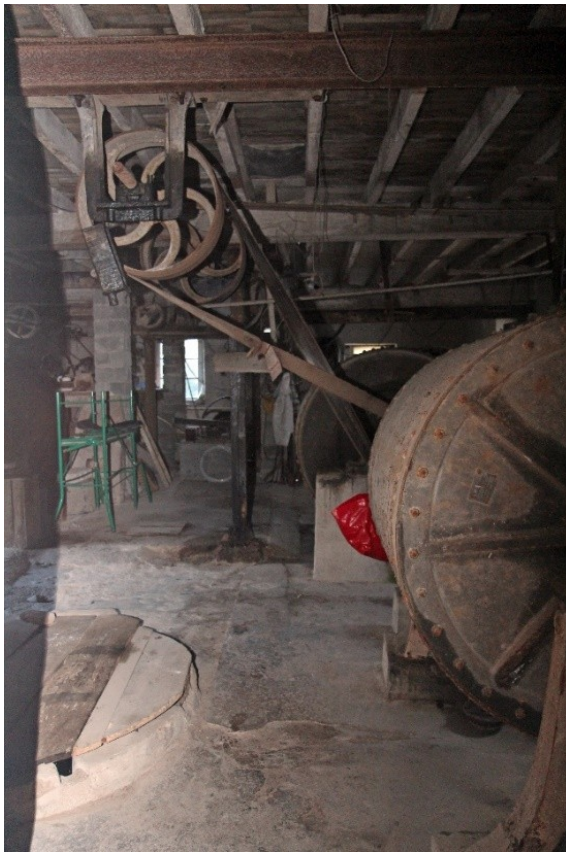
Moulin Mausset à Bosmie-l'Aiguille : broyeurs à galets avec à sa gauche la cuve de décantation du produit fini fermée par un couvercle en bois (photos Patureau).
