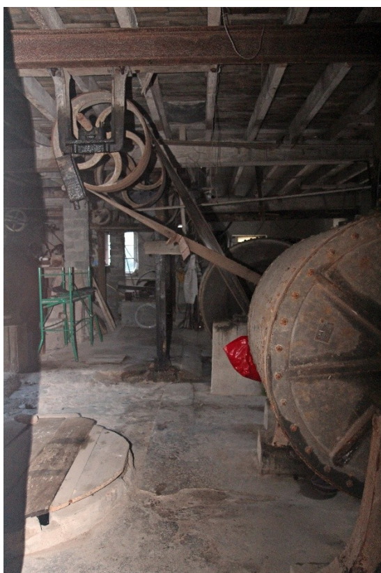
Moulin Mausset à Bosmie l'Aiguille : broyeurs à galets et à gauche la cuve de décantation du produit fini fermée par un couvercle en bois
